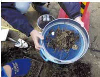
① Просеивание через сито 5 мм
