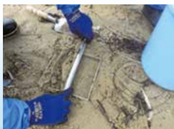
① Сбор песка с помощью рамки и дощечки
