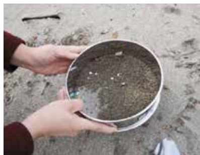
②-1 Просеивание через сито 2 мм
