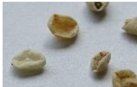
⑦ 肥料コーティングカプセル (中空球状カプセル殻)
