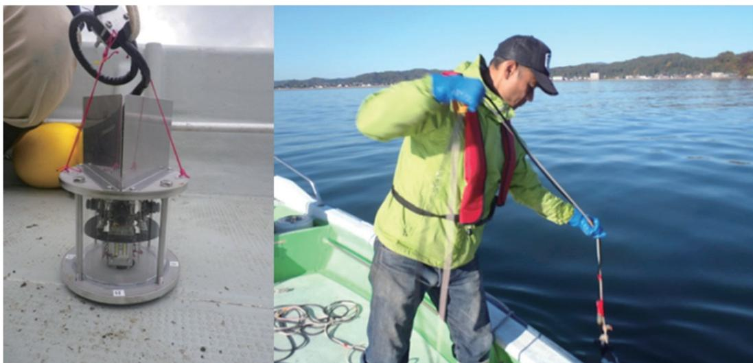
写真 2-1 垂下式水中ビデオカメラ(左)と投下の様子(右上)
